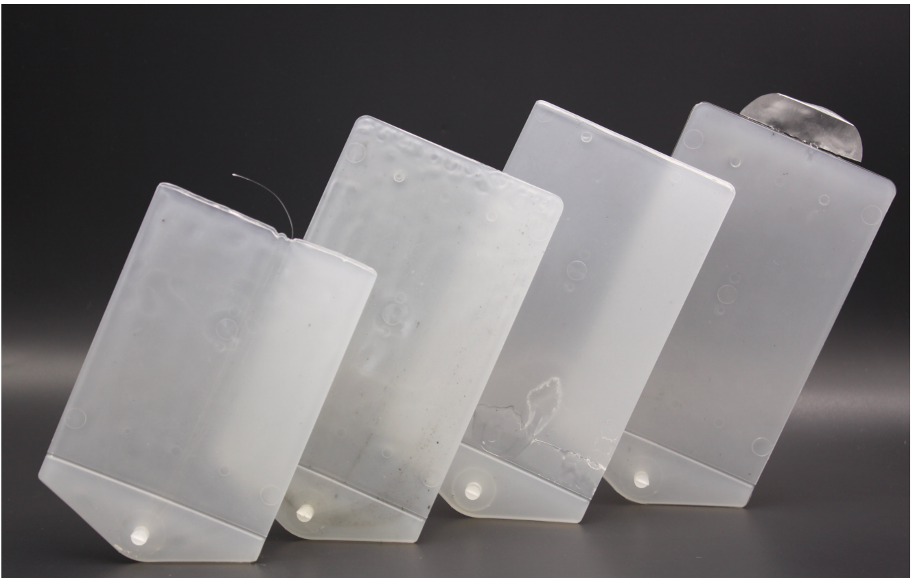
Typische Spritzgießfehler entstehen durch einen falschen Umschaltzeitpunkt zwischen Einspritz- und Nachdruckphase (© IKV)
